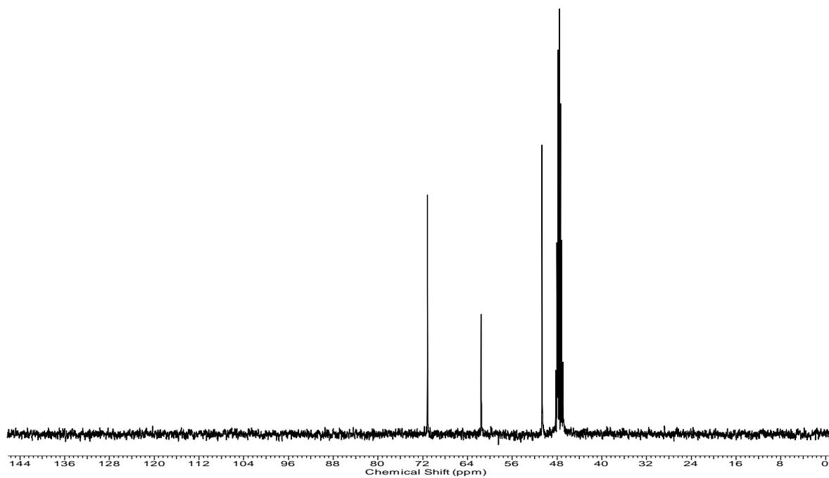
$^{13}\text{C}$  NMR spectrum (100 MHz,  $\text{CD}_3\text{OD}$ ) of 4-aminopiperidine-3,5-diol (**11**).
